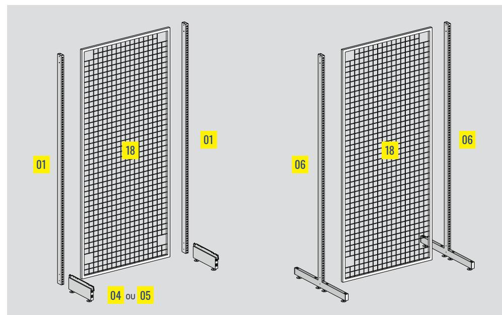
Les structures grille **18** sont à boulonner en haut et en bas des montants **01**.
