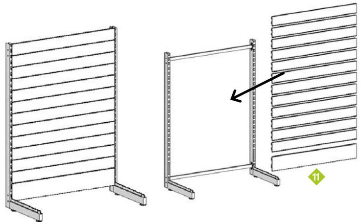
Les fonds métal multi-lames sont prévus pour recevoir des accessoires de panneaux rainurés. Cela crée un fond rainuré en métal. Ces fonds sont équipés d'accroches qui se glissent dans les perforations des montants. Simples et faciles à poser.
