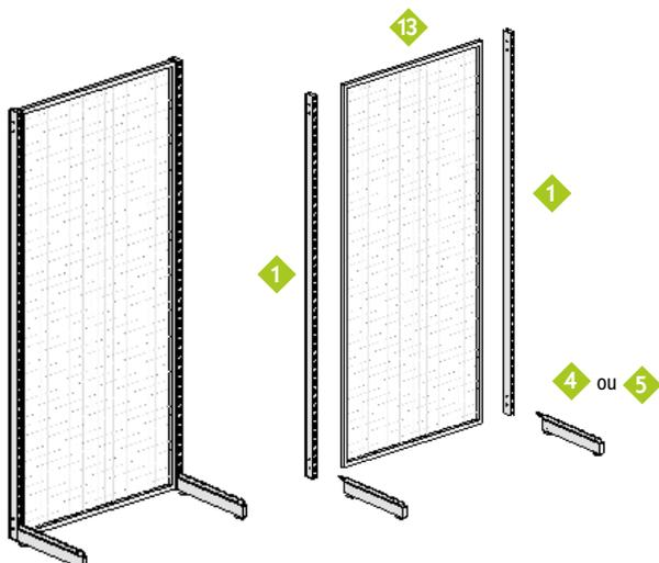
La structure grille est à boulonner en haut et en bas des montants. Cette structure est prévue pour recevoir des accessoires de grilles.
